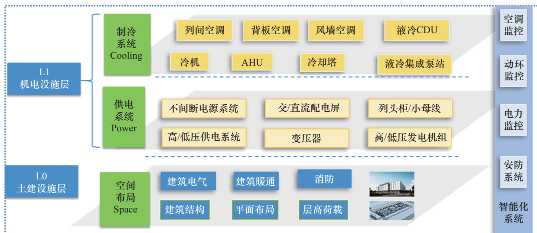
图3 数据中心基础设施层的架构
